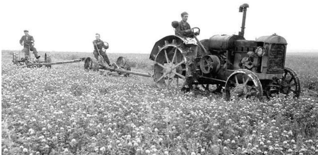
В Сталинграде 17 июня 1930 года выпущен 1-й советский трактор СТЗ-1, разработанный на основе американского трактора «Мак-Кормик Диринг 15/30».
